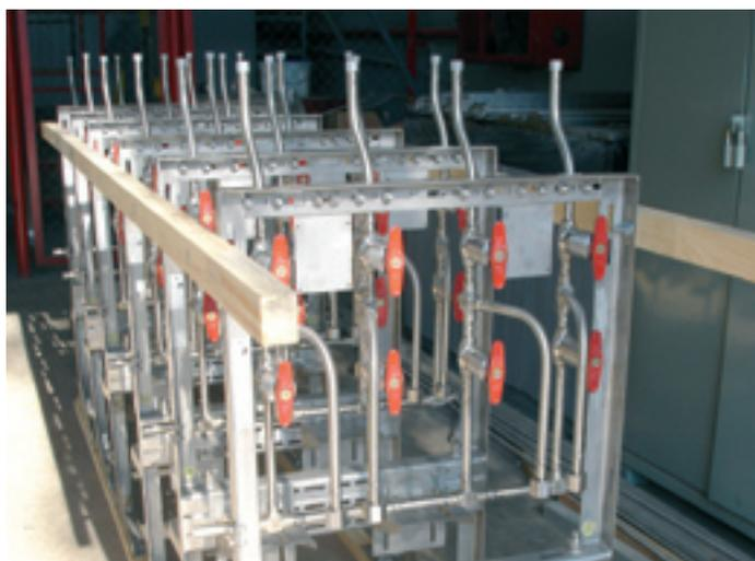
Изготовление панелей датчиков
