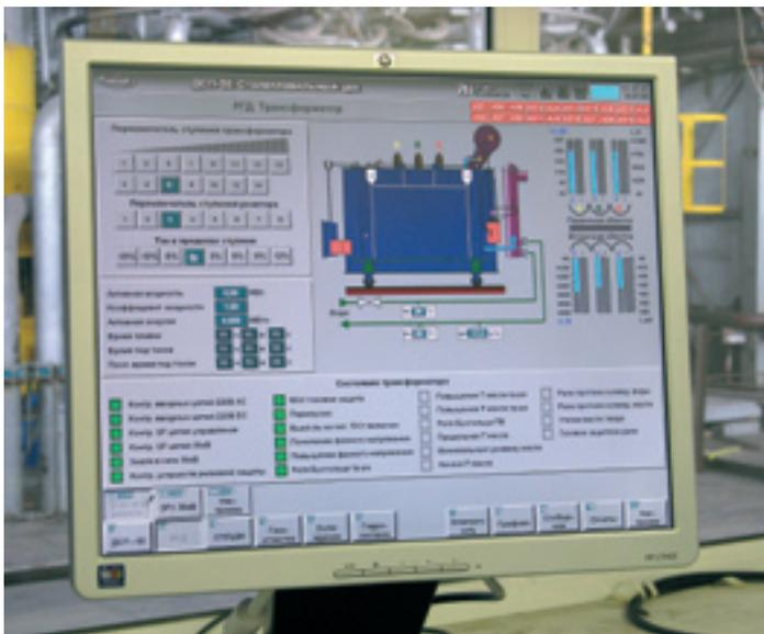
Технологическая схема печного трансформатора ДСП-50
